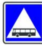
Traversée de voie de véhicules routiers des services réguliers de transport en commun
