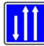
Créneau de dépassement sur section de route à trois voies
