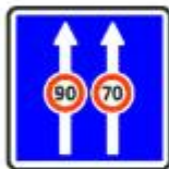
Condition particulières de circulation par voie en terme de limitation de vitesse
